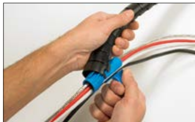
Helawrap auf das Werkzeug aufstecken.
