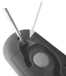
Figura 2: Apertura del vano batterie
