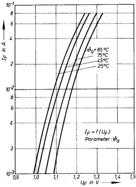
**Bild 4:** Mittlerer Durchlaßstrom der Eingangsdiode in Abhängigkeit von der Durchlaßspannung. Parameter: Umgebungstemperatur  $\vartheta_a$ . Die Zuordnung der Parameter zu den Kurven muß in umgekehrter Reihenfolge erfolgen
