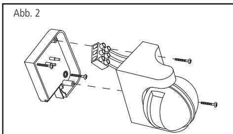
3. Ziehen Sie zunächst ein Kabel durch die Öffnung in das Gehäuse! Dieses Kabel sollte über einen Lichtschalter geschaltet werden können, denn so haben Sie die Möglichkeit den Bewegungsmelder zu jeder beliebigen Zeit ein- bzw. auszuschalten. (Abb. 2)
