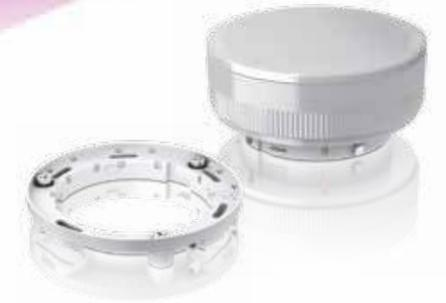
Die spezielle Sockelkonstruktion stellt sicher, dass der definierte Anpressdruck zwischen dem Silikonkissen der LIGHT ENGINE und dem Kühlkörper zuverlässig erreicht wird. Das Ergebnis ist eine konstant gute Wärmeableitung ohne Luftpolster.
