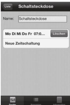
Mit der Funktion „Anlegen von Zeitschaltungen“ können Sie das **iComfort** Funksystem auch als einfache Zeitschaltuhr verwenden. Sie können 32 Schaltzeiten anlegen, die automatisch im **iComfort** Gateway gespeichert werden.
