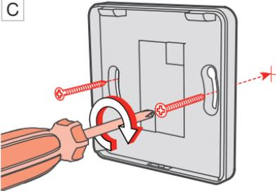
Befestigen Sie die Rückseite des Gehäuses an der Wand.
