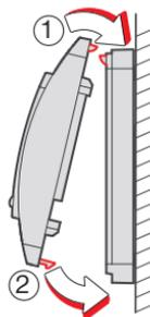
Stecken Sie die vordere Abdeckung auf die Gehäuserückseite
