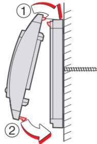
Stecken Sie die vordere Abdeckung auf die Rückseite des Gehäuses.
