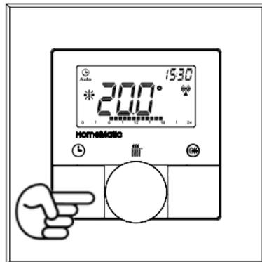
Menüpunkte werden mit dem Stellrad ausgewählt und mit der Boost-Taste (🔥) bestätigt. Ein erneuter Druck der Auto-/Manu-Taste (🕒) führt zur vorherigen Ebene zurück. Nach jedem Menüpunkt wechselt das Display nach erfolgreicher Einstellung zurück zur normalen Displayanzeige.
