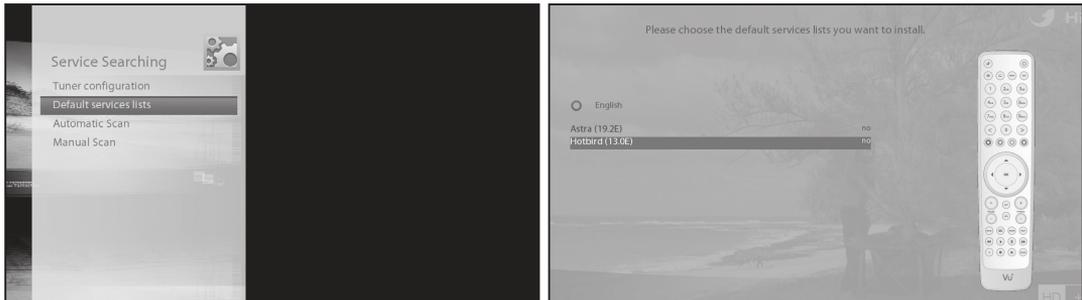
Wenn keine Standard-Senderlisten verfügbar sind, können Sie einen automatischen oder manuellen Sendersuchlauf durchführen, um TV- und Radiosender zur Senderliste Ihres Vu+ hinzuzufügen.
