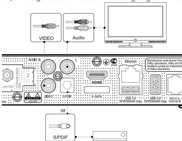
**Hinweis :** Wenn Sie einen AV Receiver mit optischem Eingang verwenden, sollten Sie die optische Anbindung für optimalen Sound nutzen.
