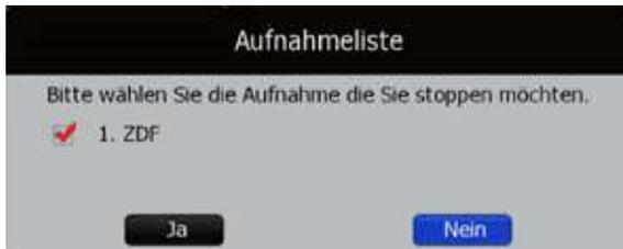
Durch Drücken der Sleeptaste, während der Aufnahme, erhalten Sie die Möglichkeit, den Receiver nach Ende der Aufnahme automatisch abzuschalten.
