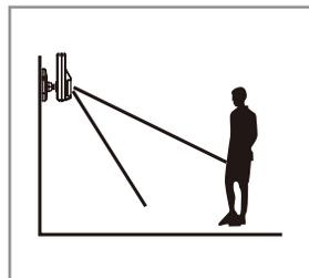
Der Sensor sollte nicht in Richtung direkter Sonneneinstrahlung stehen und in der Nähe von Wärme oder Kälte erzeugenden Geräten platziert werden (d.h. Klimaanlage, Kühler, Lüfter, Öfen, Heizungen usw.).
