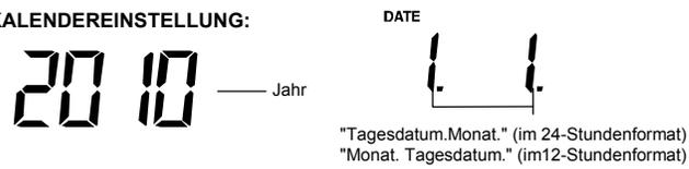
Die Kalendervoreinstellung der Wetterstation nach der Grundeinstellung ist der 1.1. des Jahres 2010. Wird das funkgesteuerte DCF-77-Zeitsignal empfangen, wird damit automatisch auch das Kalenderdatum auf den neuesten Stand gebracht. Ist kein DCF-77-Signalempfang möglich, so kann das Datum auf folgende Weise auch manuell eingestellt werden:
