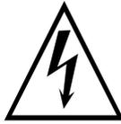
Ein Dreieckssymbol mit einem Blitz macht den Anwender auf eine nicht isolierte "gefährliche Spannung" im Gehäuse aufmerksam, die so hoch sein kann, dass die Gefahr eines Stromschlags besteht.
