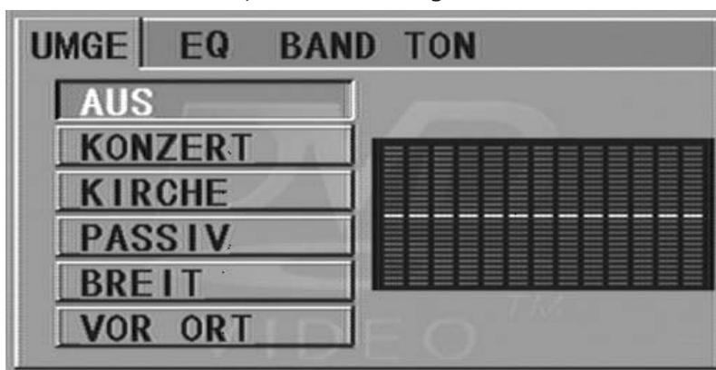
Mit Hilfe von Halleffekten kann das Gerät die Akustik verschiedener Umgebungen simulieren. Wählen Sie mit den  $\blacktriangle$   $\blacktriangledown$  Tasten die gewünschte Umgebung aus und drücken Sie die ENTER-Taste.
