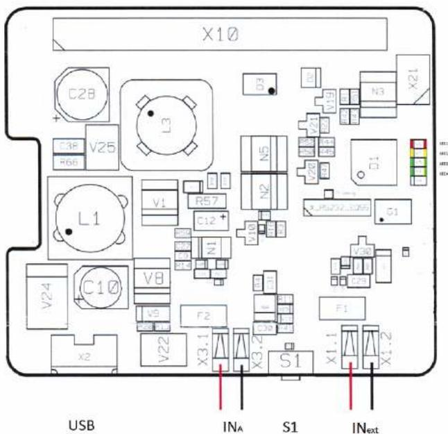
Abbildung 2.1: Anschlussbelegung USV+
