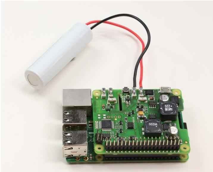
Abbildung 3.4: USV+ auf Raspberry Pi mit Akku
