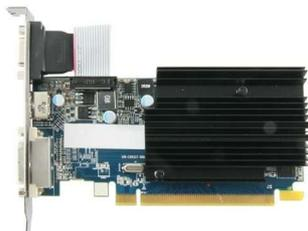
Sapphire 11233-01-20G. Grafikprozessorenfamilie: AMD, GPU: Radeon R5 230, Maximale Auflösung: 1920 x 1200 Pixel. Separater Grafik-Adapterspeicher: 1 GB, Grafikkartenspeichertyp: GDDR3, Speichertaktfrequenz: 1334 MHz. Schnittstelle: PCI Express x16, HDMI-Version: 1.4a. Kühlung: Passiv, Produktfarbe: Schwarz, Blau. Tiefe: 14,6 cm, Höhe: 9,4 cm, Breite: 2,2 cm
