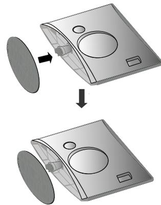
**3** Ziehen Sie die Schraube rechts herum fest, um den Monitor am Standfußsockel zu befestigen.
