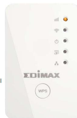
Installieren Sie den Repeater da, wo die Signalstärken- LED an ist (aber nicht blinkend) für optimale WLAN Leistung.
