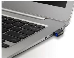
Extrem kleiner 802.11ac WLAN-Adapter
