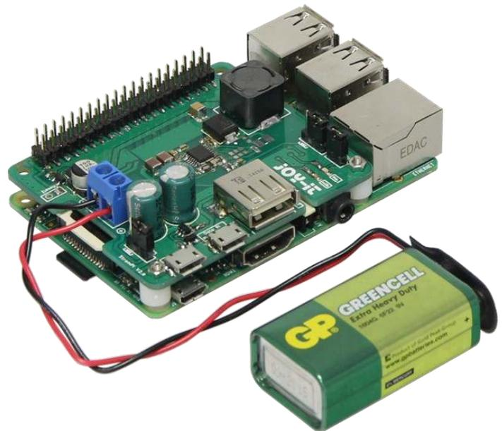
**Bestimmungsgemäße Verwendung:** Erweiterungskarte, um an einem kompatiblen Einplatinencomputer (z.B. Raspberry Pi) eine Spannungsquelle von 6V-61V anzuschließen, damit man diesen an dieser betreiben kann.
