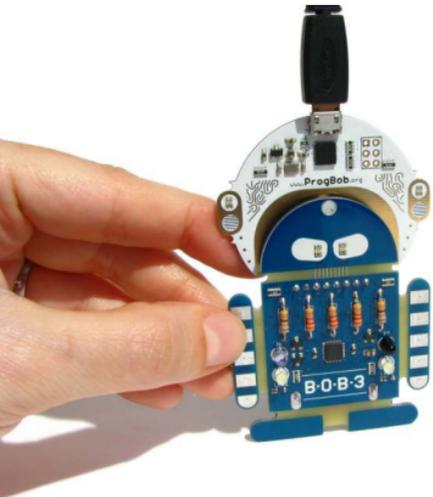
ProgBob-Helm auf den B-O-B-3 aufstecken und den Helm über USB mit dem Rechner verbinden.
