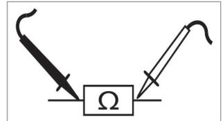
**Hinweis:** "OL" (Overload) ist ein Hinweis darauf, dass der Messkreis unterbrochen oder dass der Widerstand  $\geq 2 \text{ M}\Omega$  ist. Achten Sie darauf, dass die Messspitzen sauber sind, um eine Verfälschung der Messwerte zu vermeiden.
